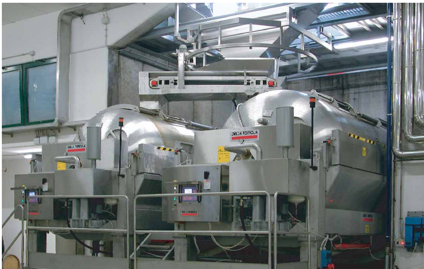
▼ Impianto di automatico di riempimento dal portello per coppie di presse Automatic system for filling through the hatch, for paired presses Automatische Füllanlage ab Klappe für zwei Pressen Installation automatique de remplissage par la porte pour paires de presses Sistema automático de llenado desde la escotilla para pares de prensas
